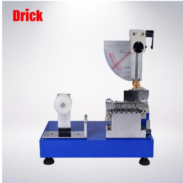
DRK182A 层间剥离强度试验仪主要用于纸板之纸层剥离强度即纸张表面纤维间结合强度的试验仪器。
