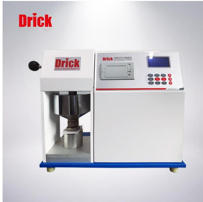
DRK105 平滑度测定仪是根据国际通用的别克(Bekk)式平滑仪工作原理设计研发的一款智能型纸与纸板平滑度性能检测仪器，是各种高平滑纸检测所必备的仪器。本平滑仪用于高平滑纸与纸板的测试工作，不应用于测试厚度在 0.5 mm 以上的材料或透气度大的纸或纸板，因为透过试样的空气量可造成不真实的结果。
